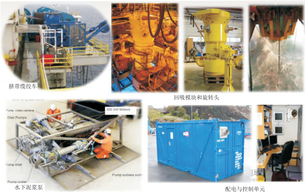
图 1 RMR 系统模块 Fig.1 Modules of RMR
