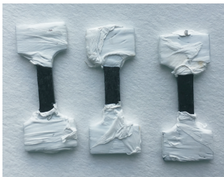
图 1 两端包裹的预腐蚀铝合金拉伸试样
