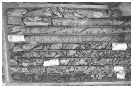
图 1 破碎地层岩心
