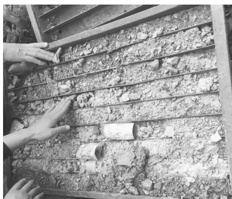
图2 绿泥石化地层岩心
