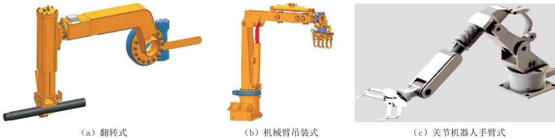
图 4 加卸钻杆装置结构示意图
