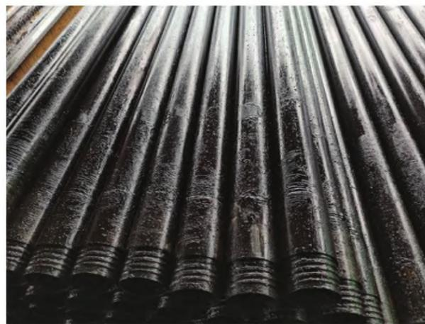
图7 钻进使用后附着在钻杆表面的润滑脂状态
