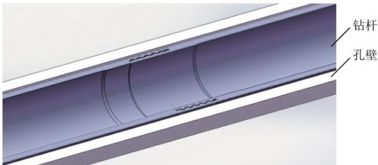
图 4 钻柱装配体部分剖面
