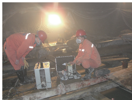
图 1 声波、CT 探测
