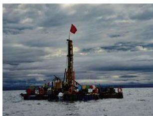
此次钻取湖芯是我国科学家和工程技术人员完全依靠自主设计的采样平台、套管稳定系统和钻探系统取得的,对我国湖泊钻探方面具有重要意义。专家预计,获取的湖芯样本可以分析过去15万年以来青藏高原中部的气候环境变化历史。
