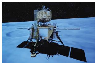
嫦娥五号着陆器和上升器组合体完成了月球钻取采样及封装。嫦娥五号探测器自动采样任务采用表钻结合、多点采样的方式,设计了钻具钻取和机械臂表取两种“挖土”模式。
