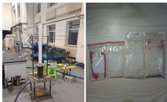
(a) 实验装置 (b) 不同粒径的聚丙烯颗粒 图6 实验台实物
