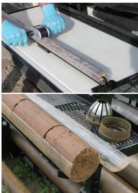
图6 直推钻具取样效果
