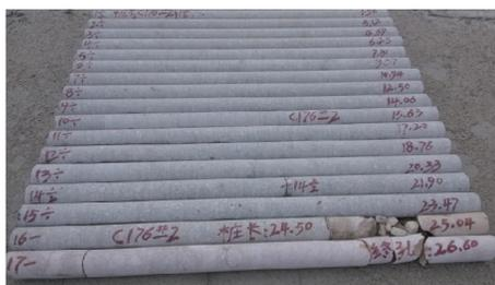
图1 钻芯法检测结果(典型溶洞)
