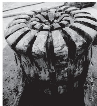
图6 改进后Ø333 mm 表孕镶金刚石全面钻头出井后照片
