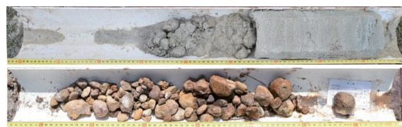
图6 BZK01部分松散地层取心效果
