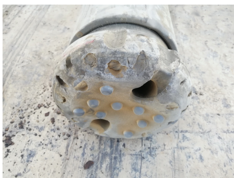
图1 GH-01井空气潜孔锤钻头磨损情况
