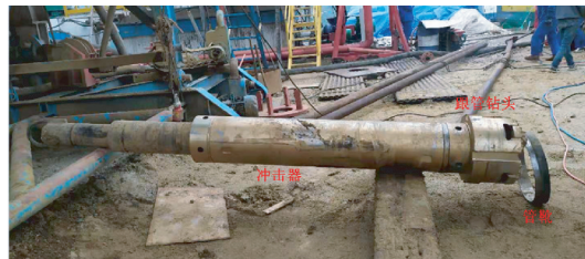
图4 黔水地1井所用跟管钻具 [18]
