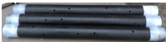
图10 跟管钻进护孔套管
