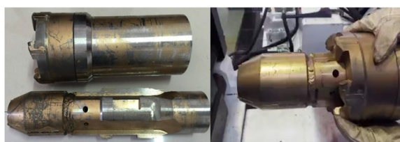
图9 \varnothing 102 mm / \varnothing 140 mm 滚珠钻具实物
