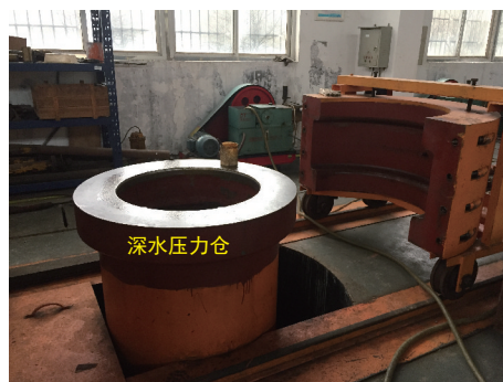
(b) 深水压力仓打压测试
