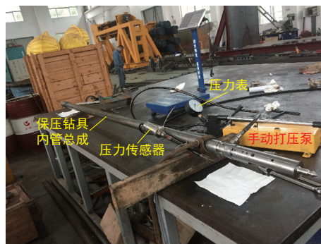
(a) 手压泵打压测试
