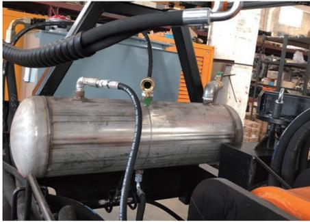
图3 风水除尘装置实物
