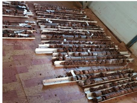
图8 冲击取心钻进采取的岩心
