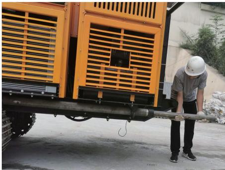
图5 岩心快速退取装置
