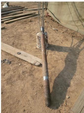
图9 下注一体化系统端部组装示意
