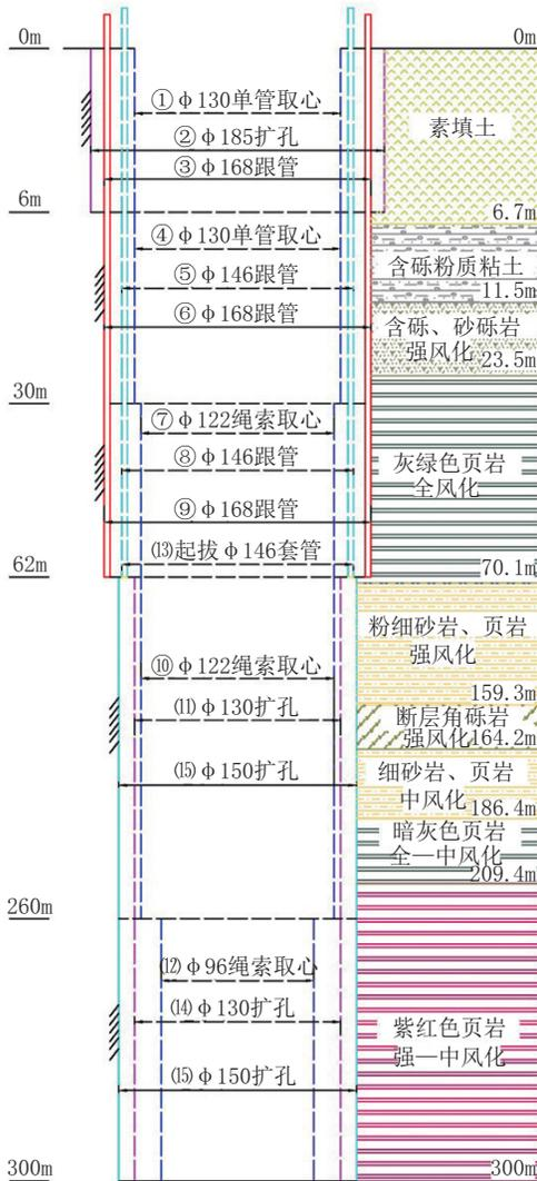
图4 钻孔结构及钻扩工艺流程
