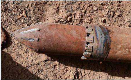
图7 一级导向扩孔钻头结构型式
