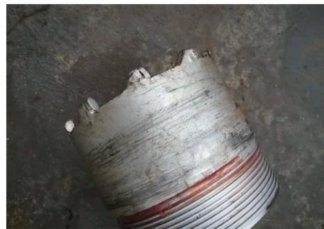
图6 跟管管靴复合片钻头
