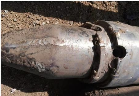
图8 二级导向扩孔钻头结构型式
