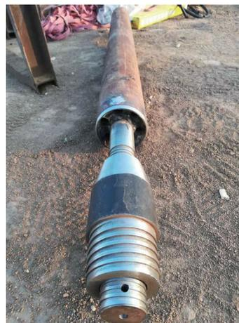
图10 反丝解脱接头
