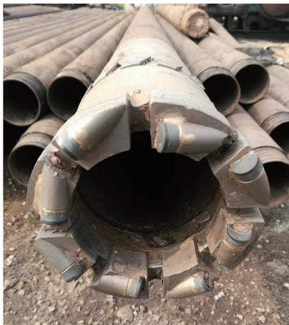
图5  $\phi 122$  mm 绳索取心金刚石复合片钻头
