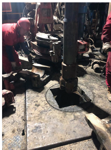
图6 12\frac{1}{4} in连续取心钻头下井试验
