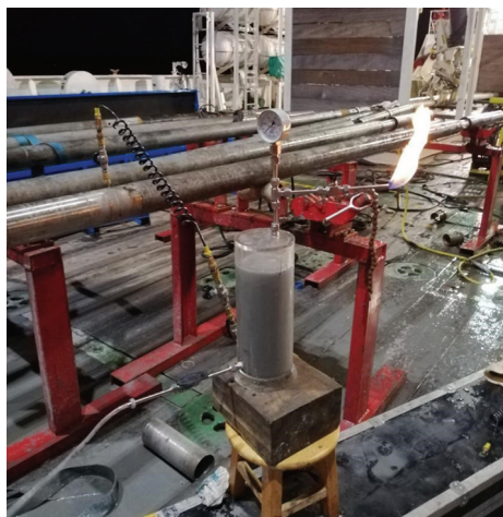
(a) 对样品管中收集的气体点火成功
