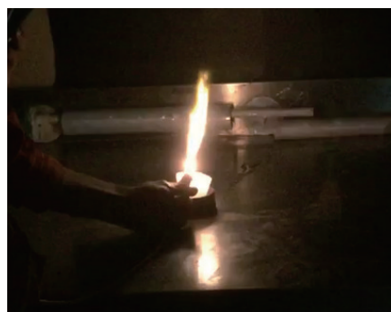
(b) 利用收集到的分解气进行点火
