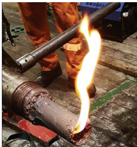
(b) 样品管泄压后点火成功
