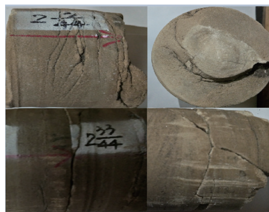
图2 柯坪塔格组岩心裂缝
