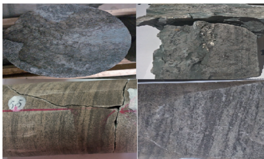
图1 塔塔埃尔塔格组岩心裂缝
