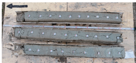
图6 单回次粗砂层取心效果
