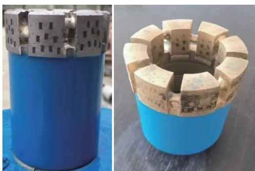
图3 高效长寿命金刚石钻头
