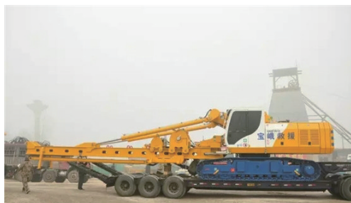
图3 德国宝峨RB-T90型车载钻机
