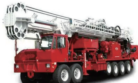
图2 美国雪姆 T200型车载钻机
