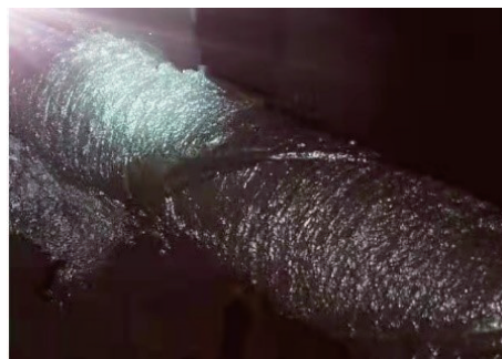
图3 煤矿井下孔口钻具钻渣附着情况
