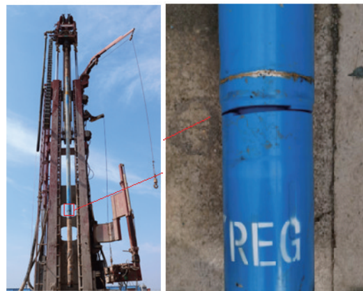
图10 震击螺杆陆地可行性试验
