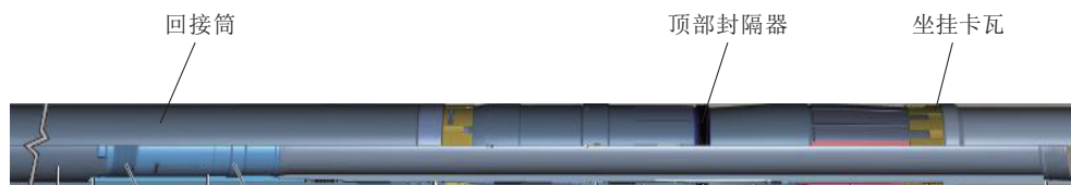
图7 LS-15尾管悬挂器单元结构示意图
