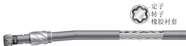
图2 螺杆钻具结构示意图
