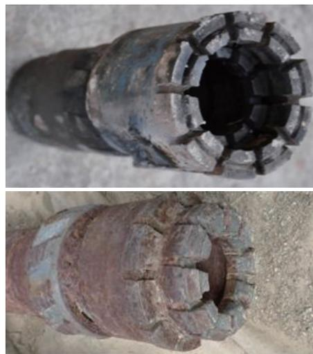
图3 现场焊接 $\varnothing 95/75$ mm钻头
