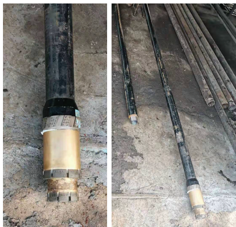
图 9 特制异径钻具及钻头
