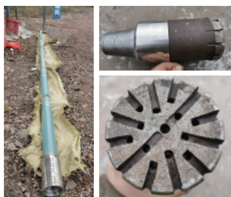
图10 侧钻采用的螺杆钻具及造斜钻头
