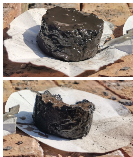
图7 成膜体系冲洗液浸泡的岩样
