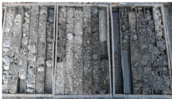
图5 捞取的孔底沉渣
