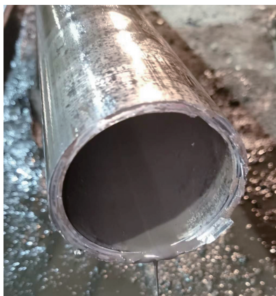
图4 水力割刀割断的事故钻杆
