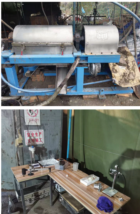
图 8 现场配备离心机及搭建的简易冲洗液测试台
