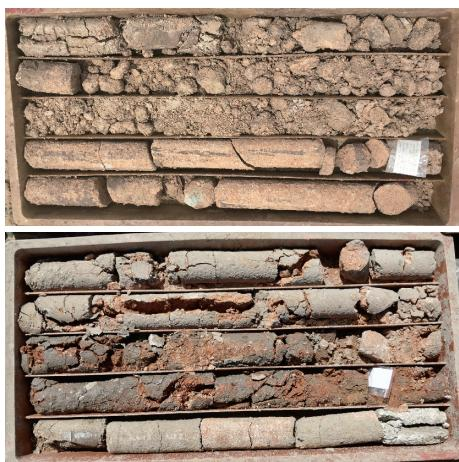
图5 ZKLH12-1孔钻取的岩心
