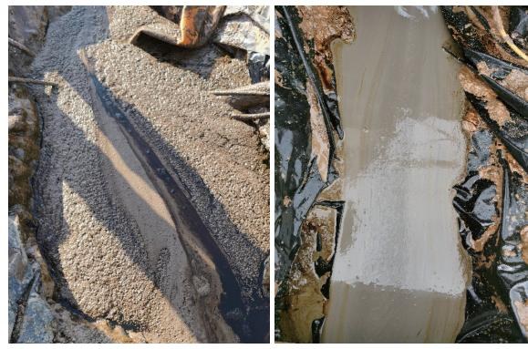
(a) 被污染的冲洗液 (b) 抗盐防塌冲洗液
