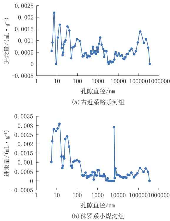
图1 岩心压汞试验曲线
