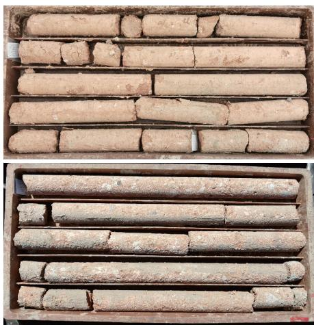
图6 ZKLH8-1孔钻取的岩心
