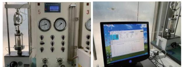
图 9 全风化泥质灰岩三轴剪切试验
