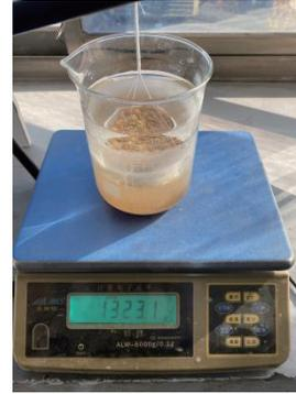
图6 崩解速率测定装置
