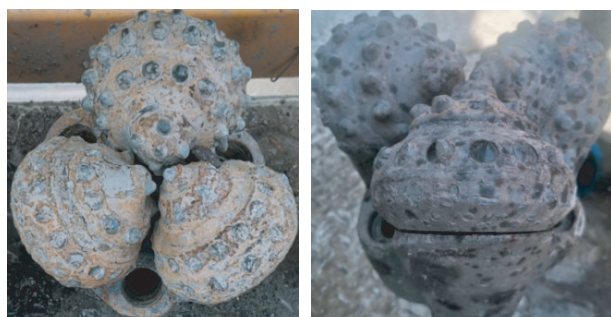
图3 Ø215.9 mm井段磨损严重的LS617GL型钻头照片
