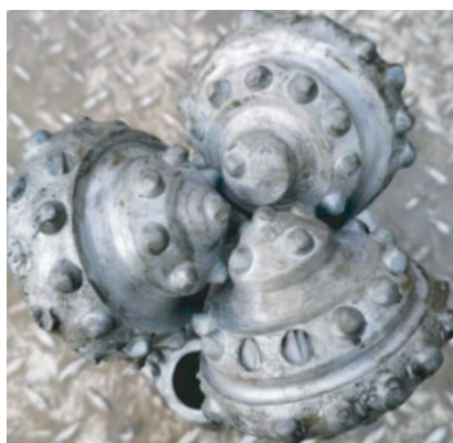
图6 Ø152.4 mm井段磨损严重的MD617HDY型钻头照片
