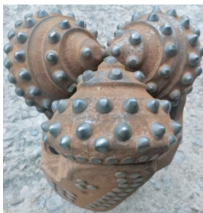
图5 \varnothing 215.9 mm井段MD617HDY型钻头磨损状况照片
