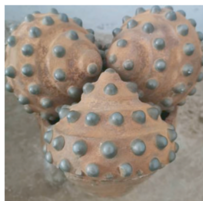
图4 Ø215.9 mm井段LST637GDH型 钻头磨损状况照片
