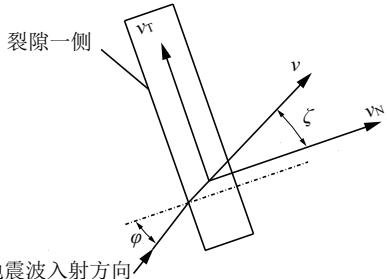
v<sub>T</sub>—沿主控结构面方向的裂隙水速度,m/s;v<sub>N</sub>—垂直于主控结构面方向的速度,m/s;φ—地震波入射角度,(°);ζ—地震波透射角度,(°)
