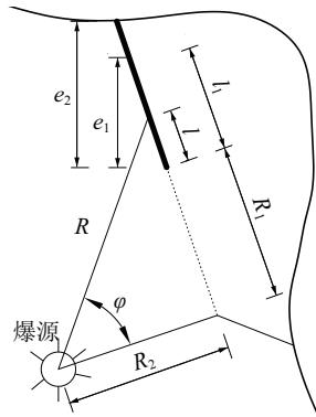
R—爆心距,m;R<sub>1</sub>—爆源沿主控结构面方向到裂隙最低端的距离,m;R<sub>2</sub>—爆源到危岩主控结构面垂向距离,m;e<sub>1</sub>—主控结构面静水高度,m;e<sub>2</sub>—主控结构面竖向高度,m;β—主控结构面与水平向夹角,(°);l<sub>1</sub>—裂隙静水高度对应的主控结构面长度,m;l—爆心距为R时对应的主控结构面距最底端的长度,m
