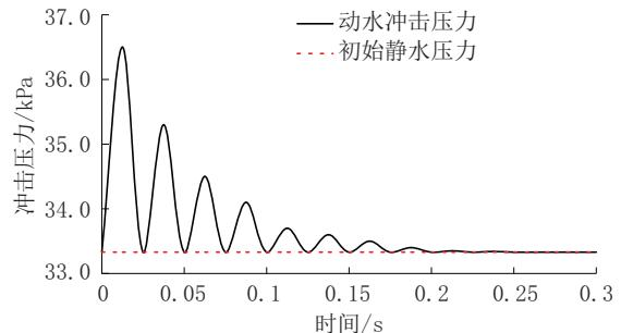
图5 裂隙最底端动水冲击压力值
