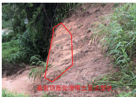
图7 基岩顶面滑带残留
