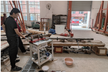
(d)地面打压试验
