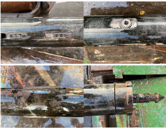
图9 弹卡机构执行正常,球阀翻转到位
