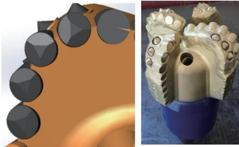
图2 穿砾石层耐磨混合PDC钻头
