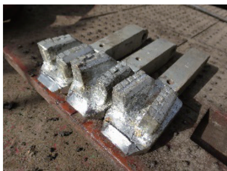
图4 锻铣工具限位器打磨后实物
