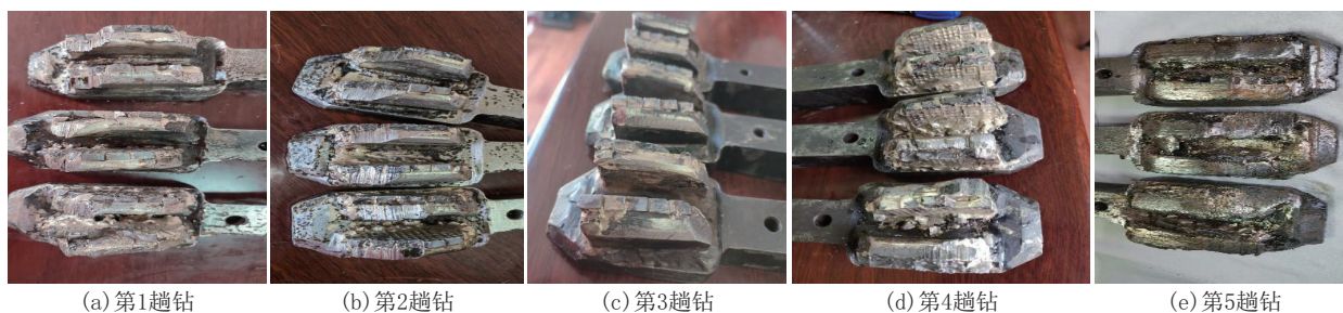
图6 锻铣工具起出后刀片磨损情况
