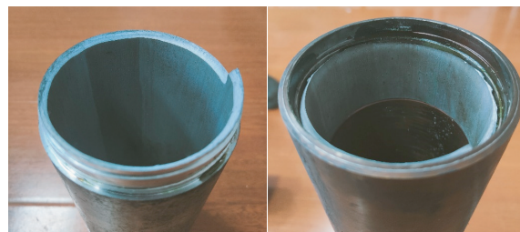
图10 铝合金钻杆与钢接头连接试样断口
