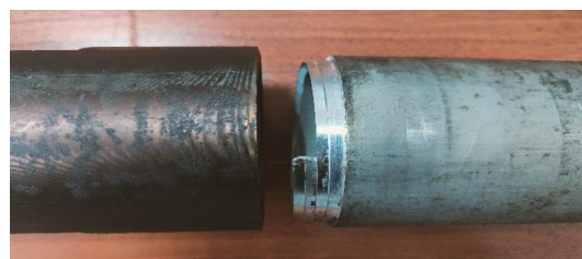
图9 断裂的铝合金钻杆与钢接头连接试样
