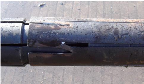
图7 膨胀管管端出现的问题
