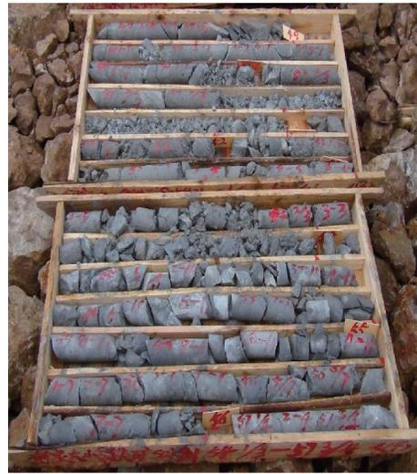
图8 SZK901孔凝灰质泥岩段的岩心
