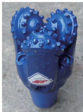
图4 \varnothing 152.4 mm 镶齿三牙轮钻头(S537G)
