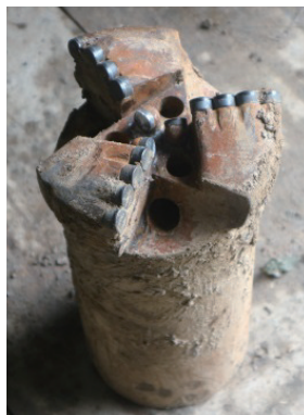
图3 \varnothing 152.4 mm PDC 全面钻头
