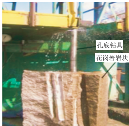
图7 在花岗岩岩块中打出的钻孔
