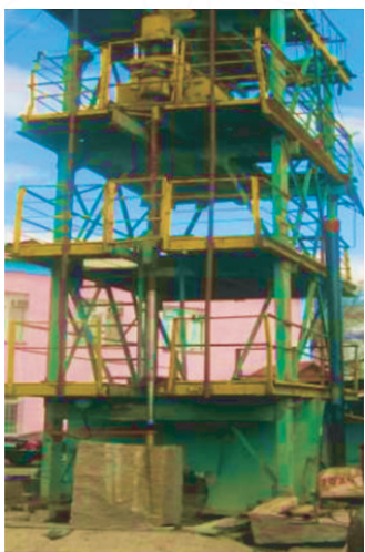
图6 试验钻进用的试验台
