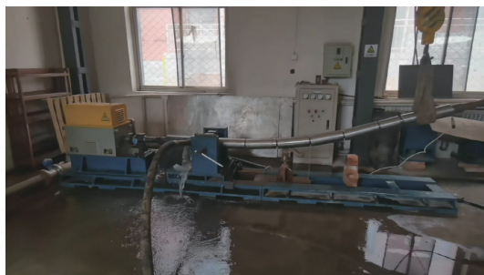
图8 柔性马达力学性能室内测试
