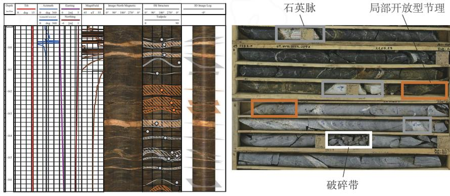
(d) 4号钻孔OTV图像和实际岩心段
