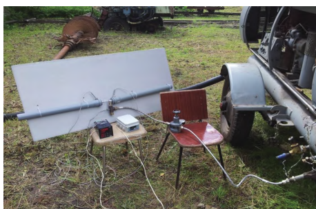
图3 旋流制冷器试验装置照片
