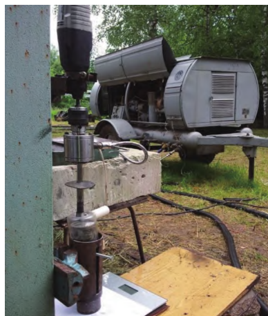
图6 空气洗井钻进实验室试验台外观照片
