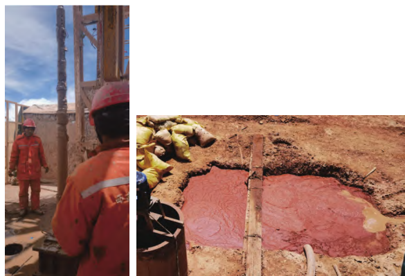
(a) 泥岩严重造浆导致钻具结垢
