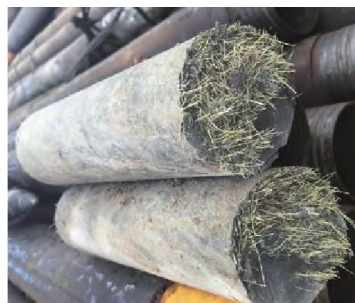
(a)套管内加筋增阻的水泥柱
