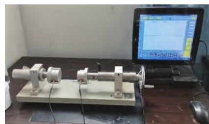
图5 岩石声波参数测试系统
