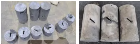
图1 所制裂隙岩石试样
