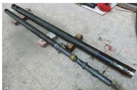
图14 碎软煤层密闭保压取心钻具内、外管总成
