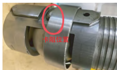
图15 球阀机构未正常工作
