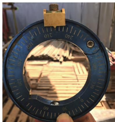
(b) 工具面方位角定位圆尺
