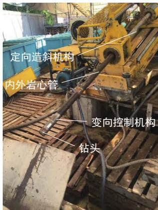
图1 DCD定向连续取心钻具
