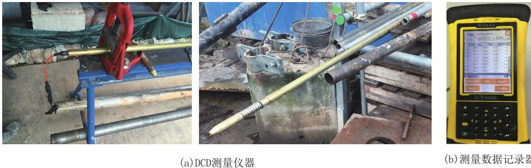
图6 DCD取心工艺钻孔轨迹测量仪器
